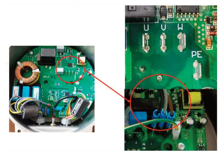
ENGAGE THE FASTONS ON THE ELECTRONICS OF THE ENGINE PHASE FOLLOWING THE FOLLOWING DIAGRAM: U-BLACK V-GREY W-BROWN PE-YELLOW/GREEN(EARTH)
